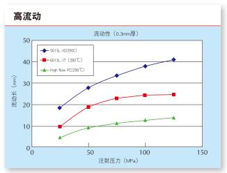
TOPAS的熔融粘度很低,具有很好的流动性,便于进行薄壁成型。同时,在注塑具复杂形状的成型品时,其转写性能极佳。尤其是光学品级为5013L-10的材料,具有优于其他光学树脂的薄壁高流动性。
