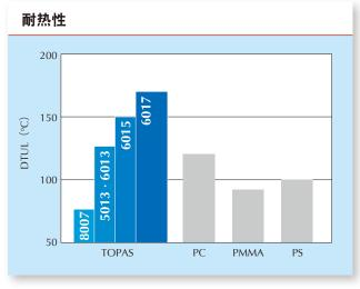
TOPAS系列产品可以适应相当宽的温度范围。载荷下最大热变形温度为170℃(玻璃化转变温度=178℃)。
