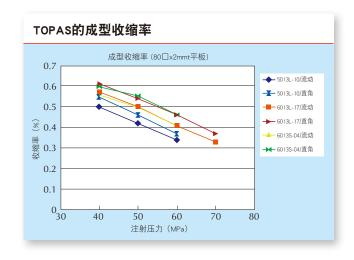
测试样品: 2mm 厚的平板 浇口尺寸: 4mm×2mm (侧浇口)
